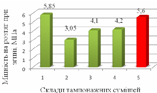
Рис. 6. Вплив добавок-модифікаторів на міцність тампонажного розчину на розтяг при згині на 2-гу добу тверднення при температурі 75 °С
