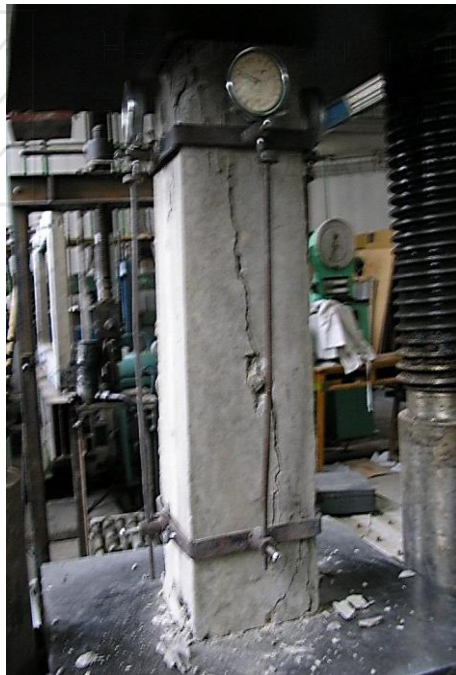
Рис. 3.4. Характер руйнування призм з високоміцних швидкотверднучих бетонів
