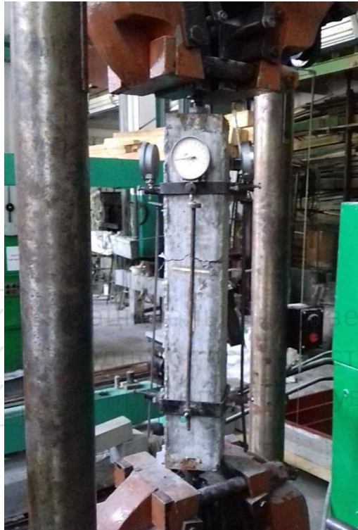
Рис. 3.7. Характер руйнування призми на розтяг з сталевібробетону
