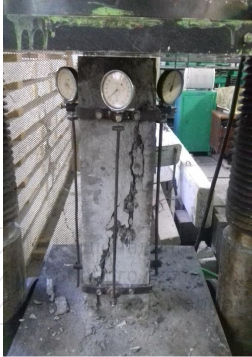
Рис. 3.6. Характер руйнування призм на стиск з сталевібробетону
