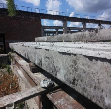
Рис. 4.3. Палі забивні С 90.30.9,1 виготовлені на основі запропонованих складів бетонних сумішей у виробничих умовах ПАТ "Рівненський завод надміцних залізобетонних конструкцій"
