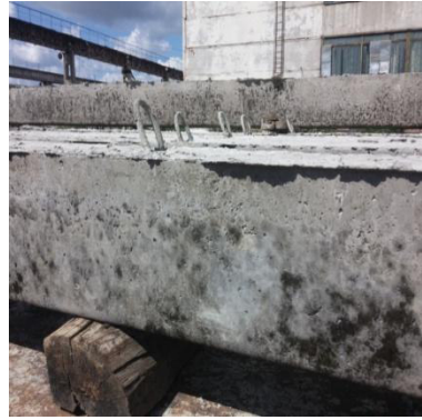
Рис. 4.3. Палі забивні С 90.30.9,1 виготовлені на основі запропонованих складів бетонних сумішей у виробничих умовах ПАТ "Рівненський завод надміцних залізобетонних конструкцій"
