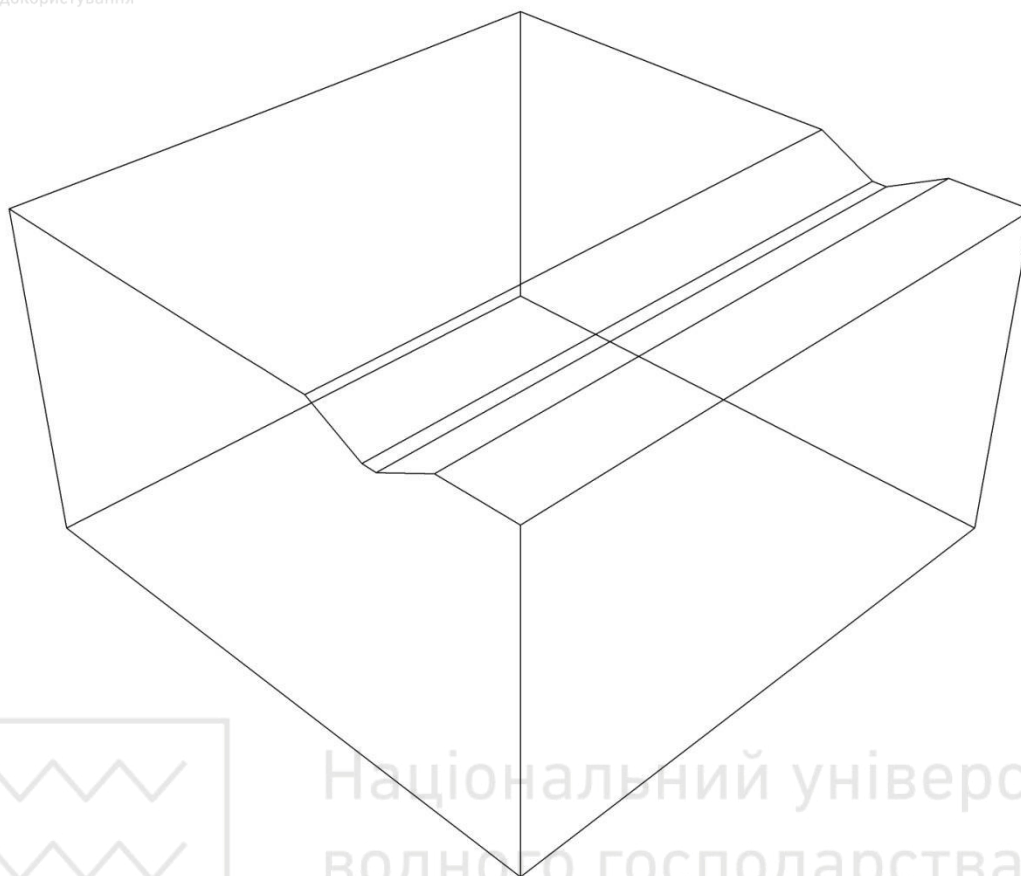
Рис. 2.119. Побудова укосів виїмки каналів (3 етап)
