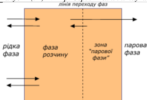
Рис. 2. Схема переходу води із фази рідини у газову фазу
