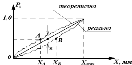
Рис. 4.11. Тягова характеристика пневматичного мембранного механізму
