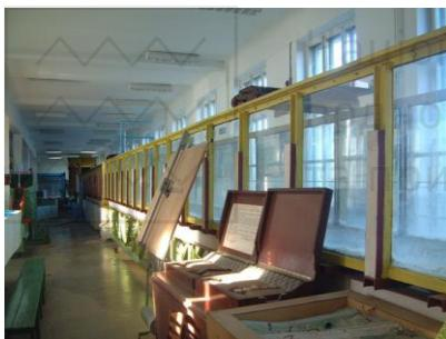
Рис. 1. Великий дзеркальний лоток (довжина 38,8 м, ширина 1,0 м, Q=500л/с)
