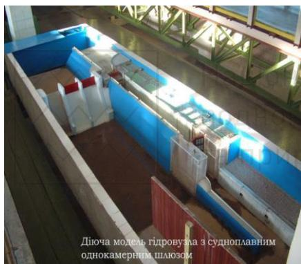
Дюча модель гідроузла з судноплавним
