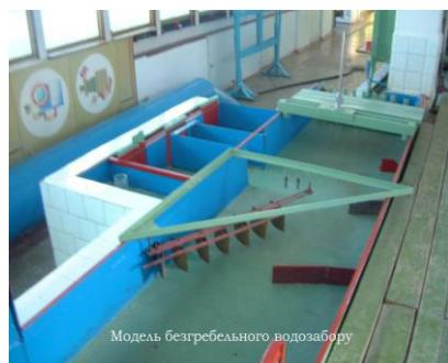
Рис. 4. Модель безгребельного водозабору (довжина 3.0м, ширина 1,0м, Q=20л/с)
