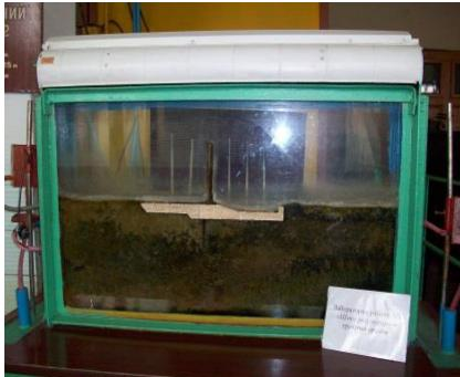
Рис.10. Фільтраційний лоток
