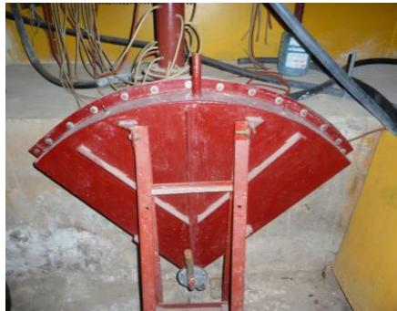
Рис. 9. Радіальна фільтраційна установка
