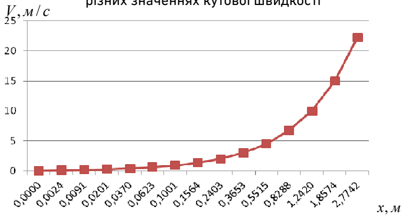
Рис. 6. Залежність швидкості частинки абразиву від переміщення x, м ( f = 0,4; r_0 = 0,05 м; \omega = 15 с^{-1} )
