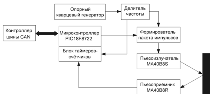
Рис. 1. Структурная схема ультразвукового одноканального дальномера
