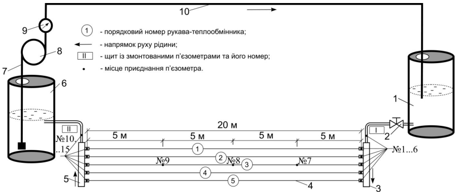
Рис. 2. Схема експериментальної установки для дослідження гідравлічних характеристик однієї секції з 5 оболонками-рукавами:
