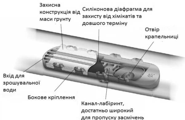
Рис. 7. Частина лабіринту та отвору
