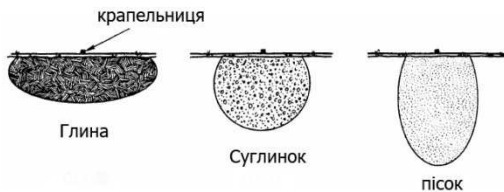
Рис. 2. Області проникнення вологи при краплинному зрошенні на ґрунтах різного механічного складу
