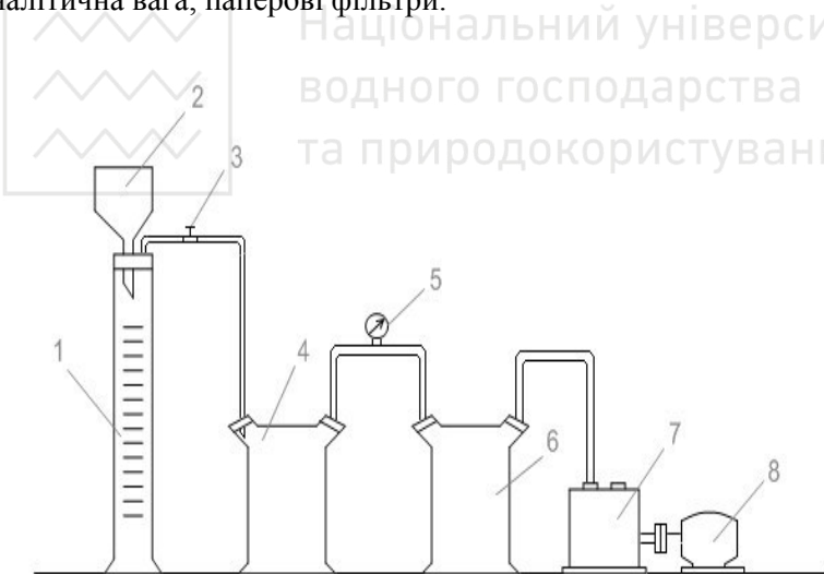
Рис. 5.1. Схема установки для визначення питомого опору осадів: 1 – мірний циліндр; 2 – лійка Бюхнера; 3 – запірний кран; 4 – ємність для збирання фільтрату; 5 – вакуумметр; 6 – ресивер; 7 – вакуум-насос; 8 – електродвигун
