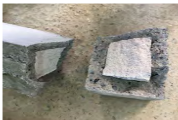
Рис. 6. Руйнування дослідних зразків Б-1 та Б-2
