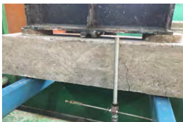
Рис. 5. Руйнування дослідних зразків Б-1п та Б-2п
