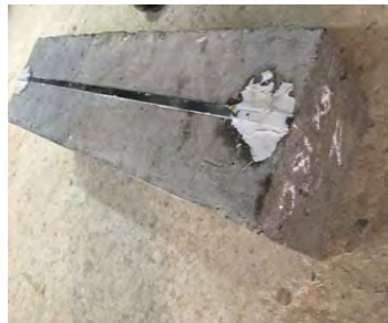
Рис. 3. Приклеювання композитної арматури
