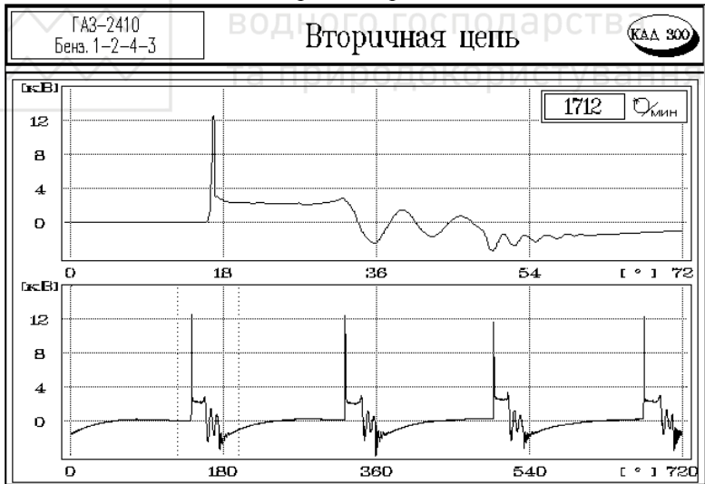
Рис. 5.12. Система запалювання з магнітоелектричним датчиком
