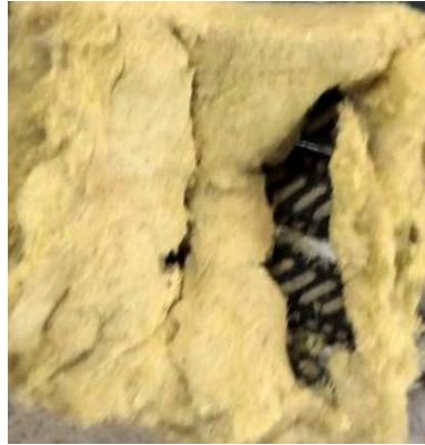
Рис. 3. Зразок після поступового навантаження до критичного (1,8 тонни)
