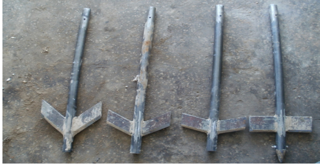
Рис. 5. Змінні робочі органи з кутами встановлення ножів \gamma_{зх} , відповідно 90^\circ, 120^\circ, 150^\circ, 180^\circ
