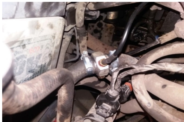
Датчик 2 – патрубок радіатора обігрівача салону
