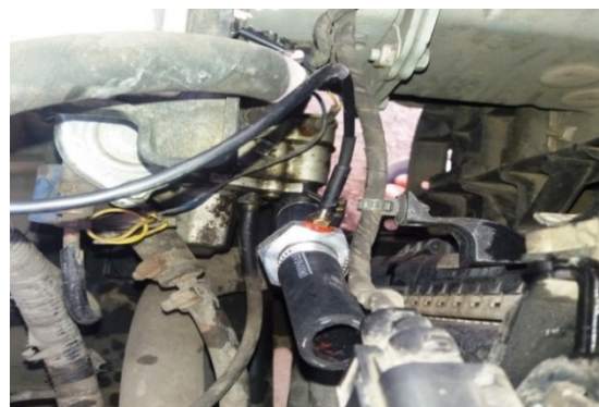
Датчик 4 – патрубок газового редуктора випарника
