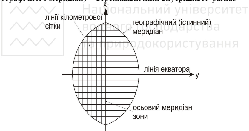
Рис. 4.1. Географічний та осьовий меридіани в проекції Гаусса-Крюгера
