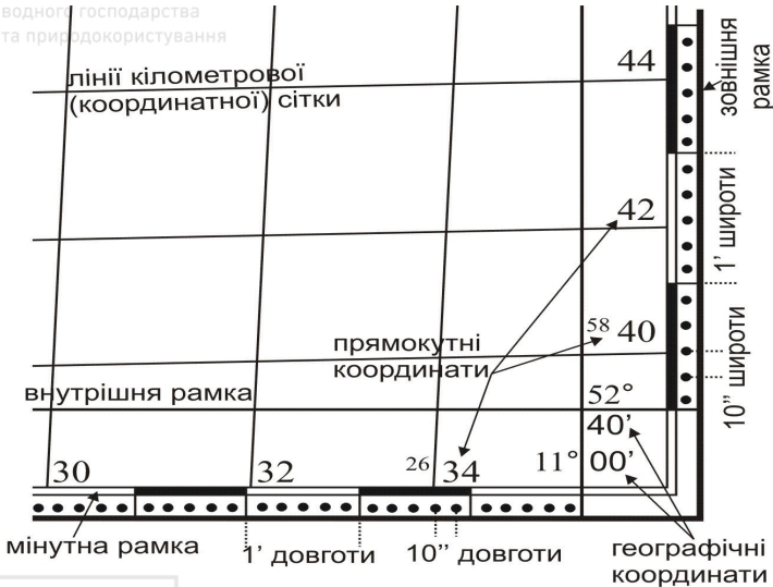
Рис. 2.3. Визначення прямокутних та географічних координат
