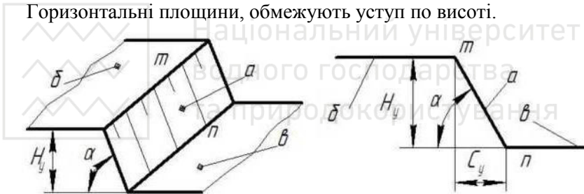
Рис. 1.1 Схема уступу при видобуванні гірських порід
