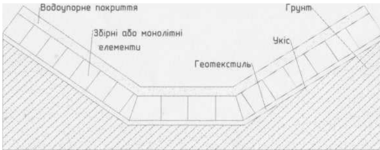
Рис. 4. Конструктивне рішення зміцнення русла георешіткою
