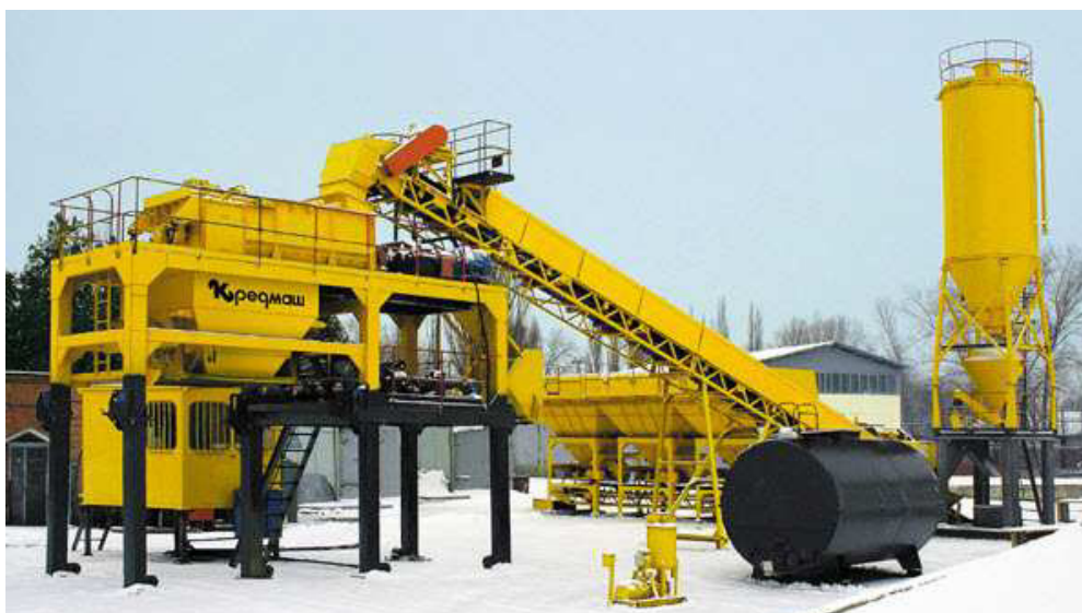
Рис. 9. Ґрунтозмішувальна установка для приготування ґрунтосуміші
