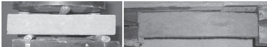
Рис. 6. Випробування грунтоцементу на розтяг: зразків-балочок на розтяг при згині (зліва) та призм на розрив (справа)
