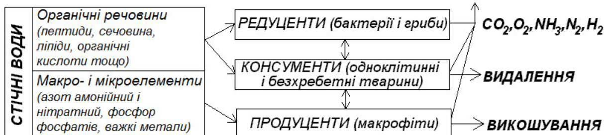
Рис. 4. Блок-схема (концептуальна модель) засвоєння та перетворення забруднювальних речовин у біоконвеєрі доочищення СВ «Рівнеоблводоканал»
