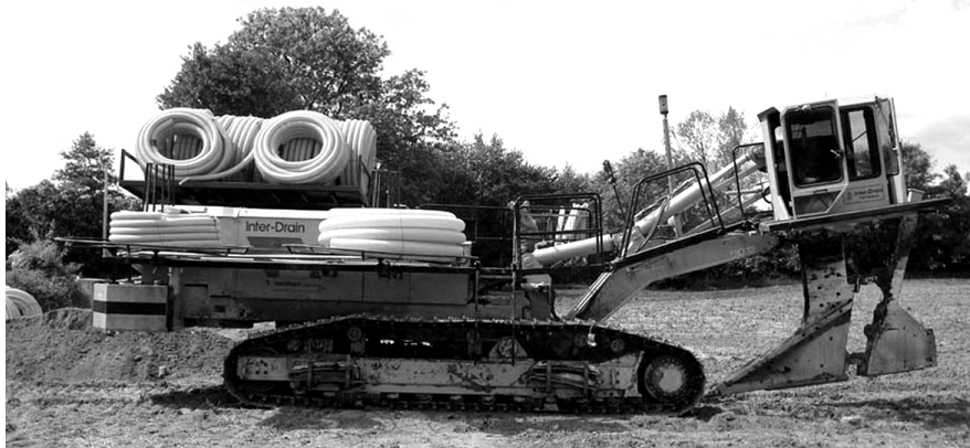
Рис. 4. Експаватор-дрепокладач Inter-Drain 2030 SP-Series
