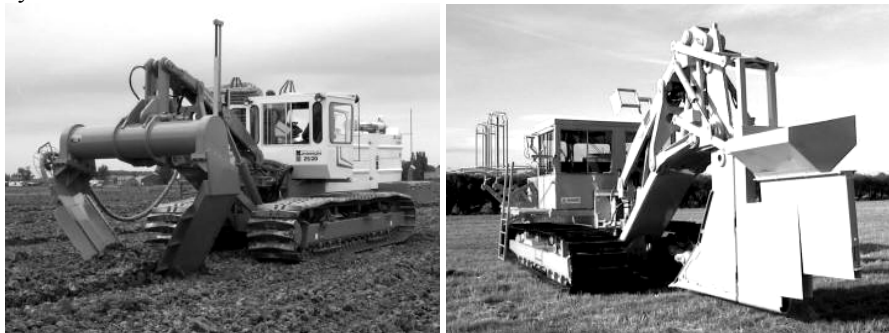
Рис. 1. Дреноукладачі фірми Mastenbroek: а) з ножом V-подібної конструкції (V-Plow); б) з одним прямим ножом (Straight Leg Plow)
